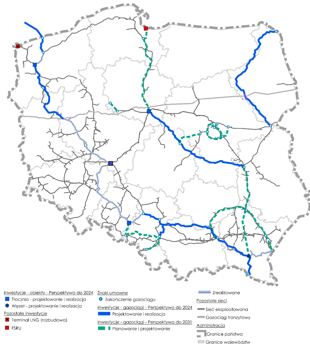
Rysunek. Planowany rozwój Krajowego Systemu Przesyłowego.
